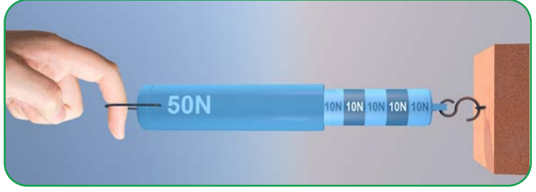
Görsel 2.1.8: Ölçebileceği kuvvet değeri ve bölme sayısı verilen dinamometre
