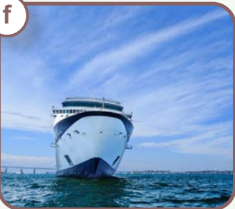
Gemilerin ön kısmının "V" şeklinde tasarlanması
